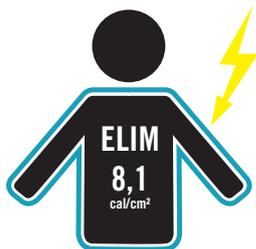
**ELIM** - Das Lichtbogenenergieniveau, vor der die PSA schützt, wenn die Wahrscheinlichkeit eines Verbrennungsrisikos zweiten Grades bei 0% liegt.
